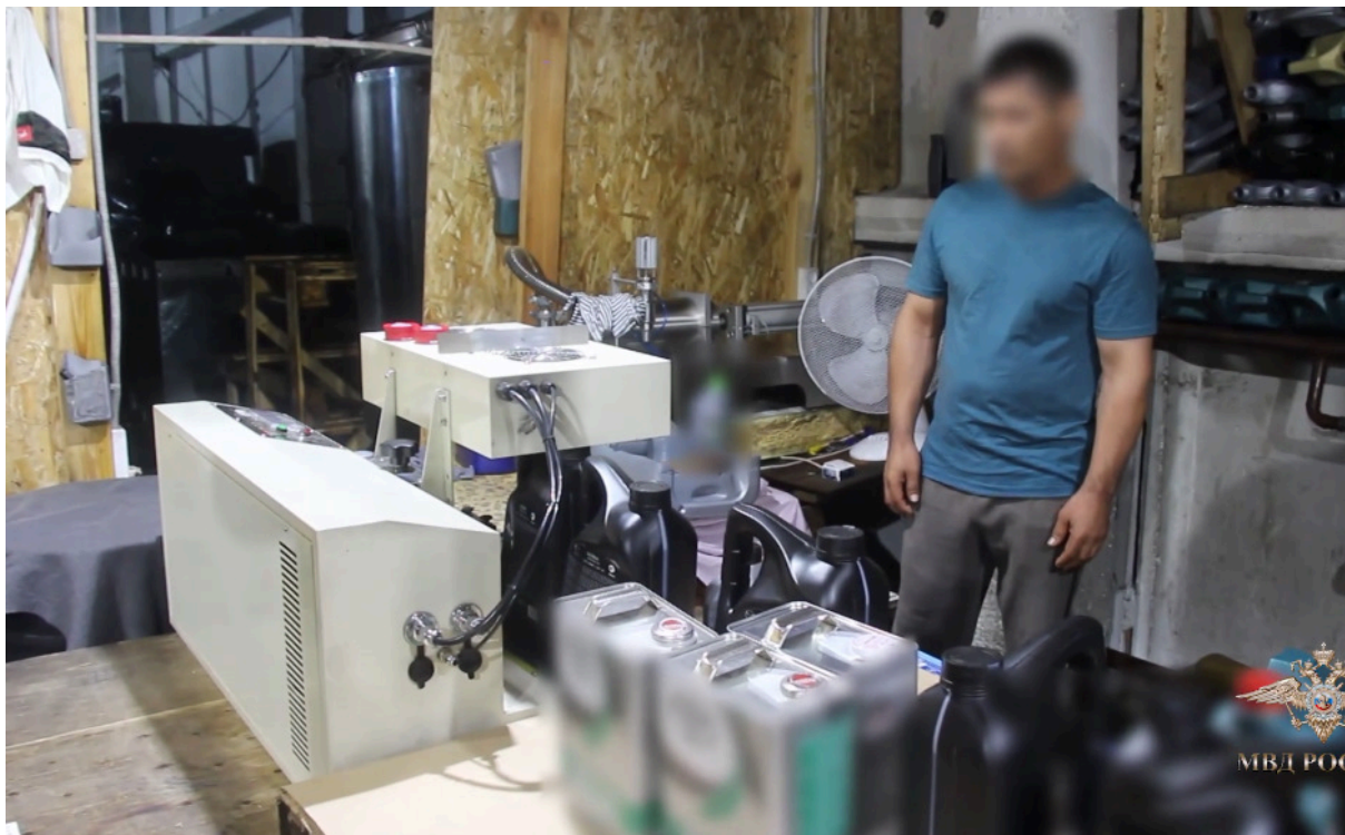
8 Канистры подаются на транспортёрной ленте к станку по закупорке канистр пробками. Обратите внимание на канистры: есть пластиковые, есть жестяные.
